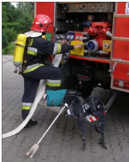
Fot. 4.3. Kierowca drugiego zastępu gaśniczego z przygotowanym sprzętem i gotowy do ewentualnego wejścia do strefy niebezpiecznej.
