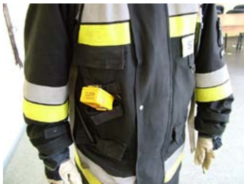
Fot. 2.4. a) Sygnalizator bezruchu umiejscowiony w okolicy brzucha. b) Sygnalizator bezruchu znajduje się pod nieprzytomnym strażakiem.
