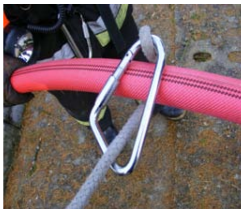
Fot. 5.13. Mocowanie liny do linii gaśniczej – sposób 2.
