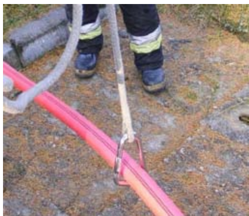
Fot. 5.12. Mocowanie liny do linii gaśniczej – sposób 1.
