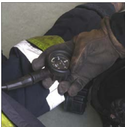
Fot. 6.12. Sprawdzenie ciśnienia w butli poszkodowanego strażaka.
