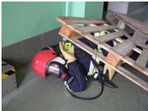
Fot. 2.11. Ręczne aktywowanie alarmu sygnalizatora bezruchu.
