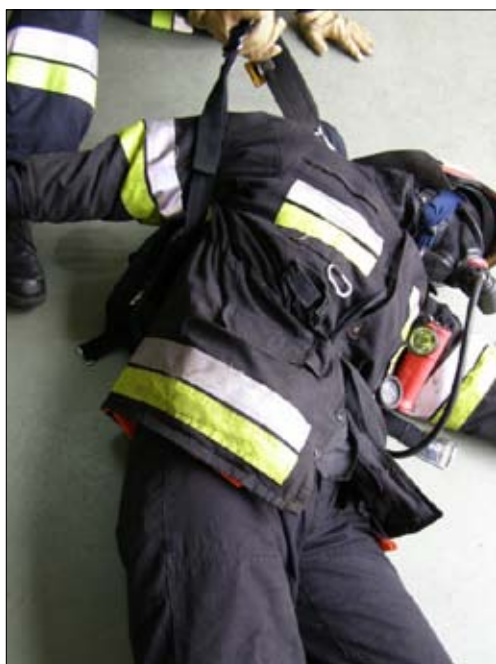
Fot. 7.6. Zsuwanie się uprząży aparatu gdy taśma biodrowa nie została zapięta.
