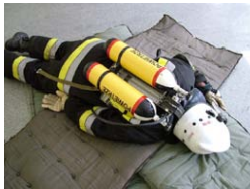
Fot. 2.4. a) Sygnalizator bezruchu umiejscowiony w okolicy brzucha. b) Sygnalizator bezruchu znajduje się pod nieprzytomnym strażakiem.
