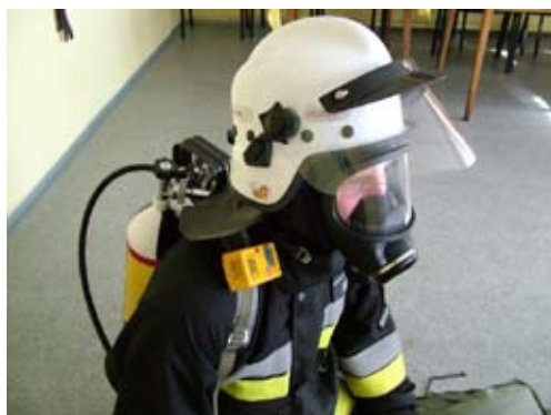
Fot. 2.5. a) Sygnalizator bezruchu przyklejony w okolicach barku. b) Pomimo tego, że strażak leży nieprzytomny, sygnalizator bezruchu nie jest całkowicie zasłonięty.
