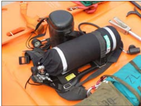
Fot. 4.6. Dodatkowy aparat z maską przygotowany dla poszkodowanego strażaka.
