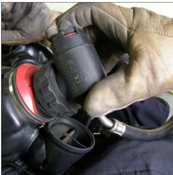
Fot. 6.15. Przedmuchiwanie maski poszkodowanego i/ lub ręczne otwarcie zaworu dodatkowego.
