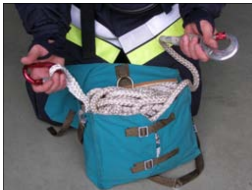
Fot. 4.9. Koniec linki z dodatkowym karabinem. Początek linki fabrycznie wyposażony w karabinek nie jest przypięty do środka torby.
