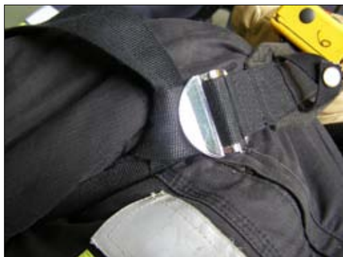
Fot. 7.7. Dodatkowy węzeł na taśmie ramiennej zapobiegający luzowaniu.
