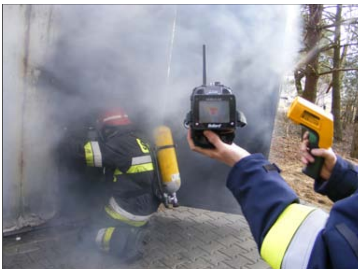
Fot. 5.23. Kamera termowizyjna z dodatkowym ekranem podglądu dla osoby kontrolującej pracę z zewnątrz.
