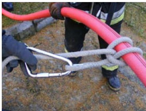
Fot. 5.14a. Mocowanie liny do linii gaśniczej – sposób 3.
