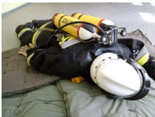
Fot. 2.5. a) Sygnalizator bezruchu przyklejony w okolicach barku. b) Pomimo tego, że strażak leży nieprzytomny, sygnalizator bezruchu nie jest całkowicie zasłonięty.
