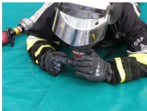
Fot. 3.15. Próba ręcznego otwarcia zaworu w automacie oddechowym.
