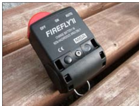
Fot. 6.6. Sygnalizator FIRE FLY II.
